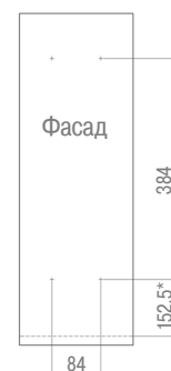
Присадочные размеры для установки фасада
